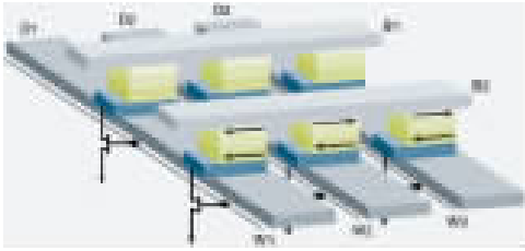
图 2 包含 MRAM 单元的存储器阵列
