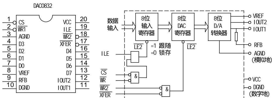
图 23 DAC0832 的引脚图及内部结构框图
