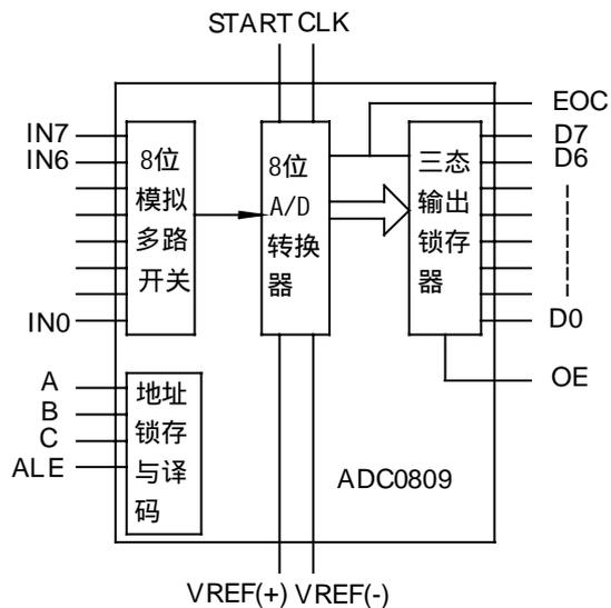
图 26 ADC0809 的内部结构框图
