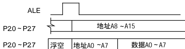
图 2 P0 口地址、数据复用示意图
