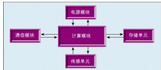
传感器节点的通信模块的功能是由 nRF903 射频收发器来实现。该收发器所具有的低功耗和小尺寸使之非常适合用于无线传感器网络系统中，该收发器可以工作在 433MHz、868MHz、915MHz 等公共频段中。射频模块通过串口与 MSP430 通信。nRF903 还可以根据输入电流来决定传输功率，这一特性使之具有以下优点：
