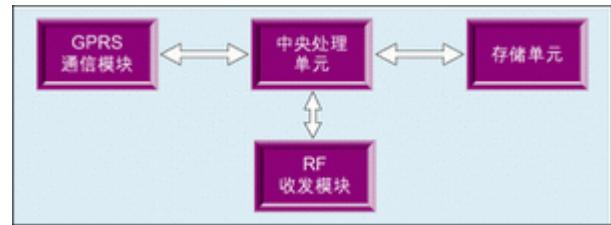
网关的中央处理单元主要用来处理从传感器节点采集到的数据以及完成一些控制功能。中央处理单元的主要器件是 Atmel 公司的 AT91RM9200 微处理器，AT91RM9200 是基于 ARM920T 指令集的 ARM 处理器。该处理器具有丰富的外设以及接口，这使得它在低成本、低功耗的条件下能完成一些功能丰富的应用。AT91RM9200 处理器集成了许多外设接口，包括 USB2.0 接口和以太网接口。此外，该处理器还提供了多个符合工业标准的通信接口，包括音频、电信、闪存卡、红外、智能卡接口等。
