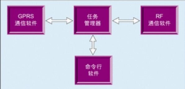
在我们的无线传感器网络系统中，软件部分主要是在网关和传感器节点上。网关端的软件主要完成的功能是处理和管理传感器节点传输过来的数据，它主要由 GPRS 通信软件、RF 通信软件、命令行软件以及任务管理软件组成，如图 4 所示。
