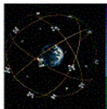
由于卫星的位置精确可知，在 GPS 观测中，我们可得到卫星到接收机的距离，利用三维坐标中的距离公式，利用 3 颗卫星，就可以组成 3 个方程式，解出观测点的位置  $(X, Y, Z)$ 。考虑到卫星的时钟与接收机时钟之间的误差，实际上有 4 个未知数， $X$ 、 $Y$ 、 $Z$  和钟差，因而需要引入第 4 颗卫星，形成 4 个方程式进行求解，从而得到观测点的经纬度和高程。事实上，接收机往往可以锁住 4 颗以上的卫星，这时，接收机可按卫星的星座分布分成若干组，每组 4 颗，然后通过算法挑选出误差最小的一组用作定位，从而提高精度。
