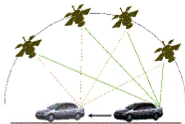
由于卫星运行轨道、卫星时钟存在误差，大气对流层、电离层对信号的影响，以及人为的 SA 保护政策，使得初期 GPS 的定位精度只有 100 米。为提高定位精度，普遍采用差分 GPS (DGPS) 技术，建立基准站（差分台）进行 GPS 观测，利用已知的基准站精确坐标，与观测值进行比较，从而得出一修正数，并对外发布。接收机收到该修正数后，与自身的观测值进行比较，消去大部分误差，得到一个比较准确的位置。实验表明，利用差分 GPS，定位精度可提高到 5 米。
