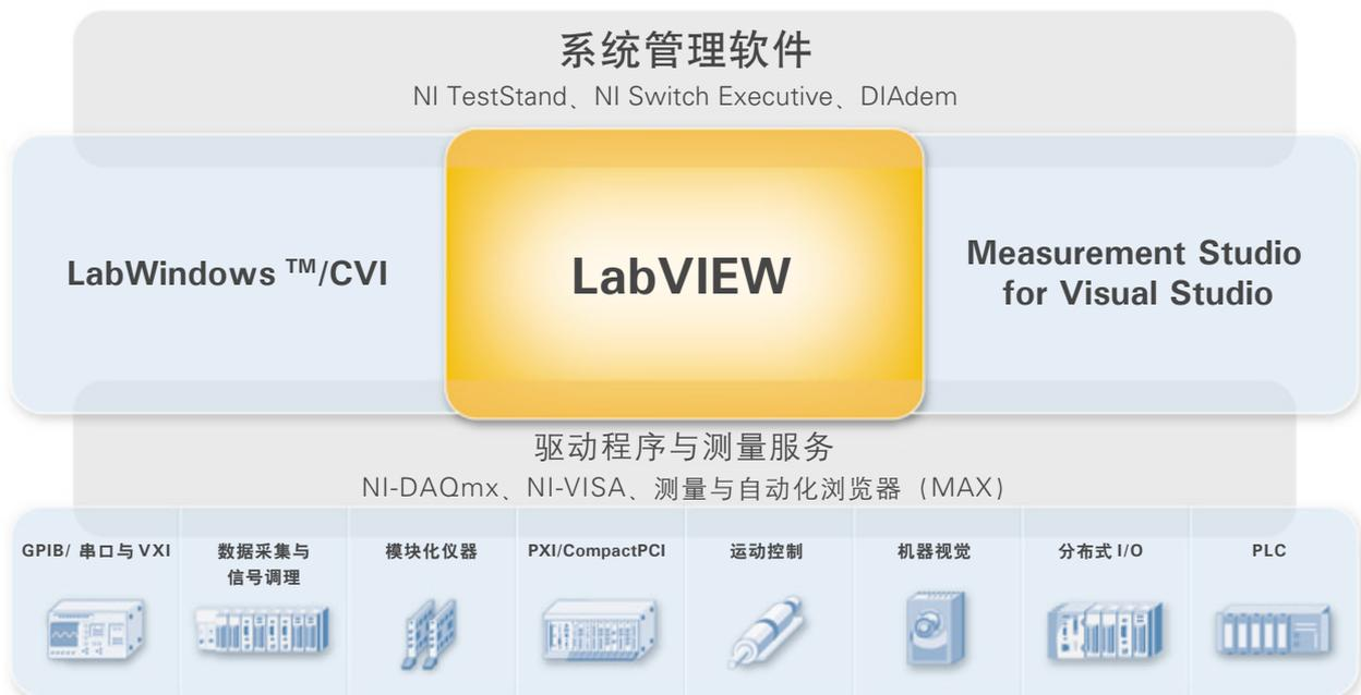
NI提供各种系统管理软件，例如专用于测试管理的NI TestStand，专用于为离线数据分析及显示的DIAdem。对于图形化、交互式以及基于文本编程的解决方案，您可以使用应用开发环境（ADE），例如NI LabVIEW、LabWindows™/CVI以及Measurement Studio for Microsoft Visual Studio。NI还提供硬件驱动程序、灵活的高级API以及配置管理器。
