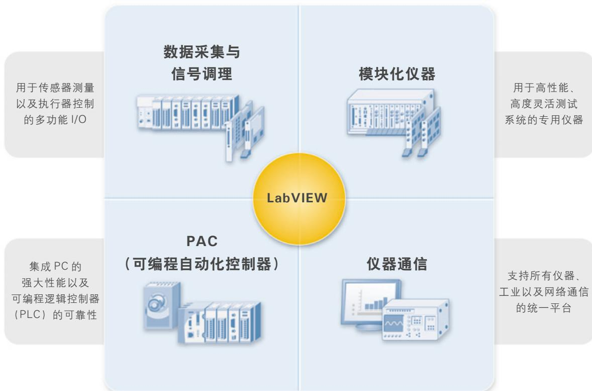
NI 数据采集 (DAQ) 设备从多种传感器采集电气或物理信号。NI 模块化仪器可以为自动化测试系统同步测量、信号产生、射频以及开关组件。对于工业测量和控制应用而言，NI PAC (可编程自动化控制器) 将 PLC 的可靠性与 PC 的性能集成在一起。对于仪器控制和通信，NI 提供了包括 GPIB、USB、以太网和串行接口在内的多种接口类型。
