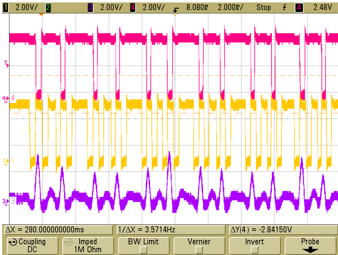
图 4 验钞机系统磁性检测模块磁信号波形示意图
