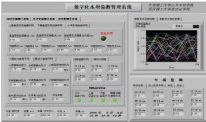
图6 数字化水坝监测管理系统的监测界面 (图上显示了在2004年5月11日的一次监测时安全监测子系统的检测结果)
