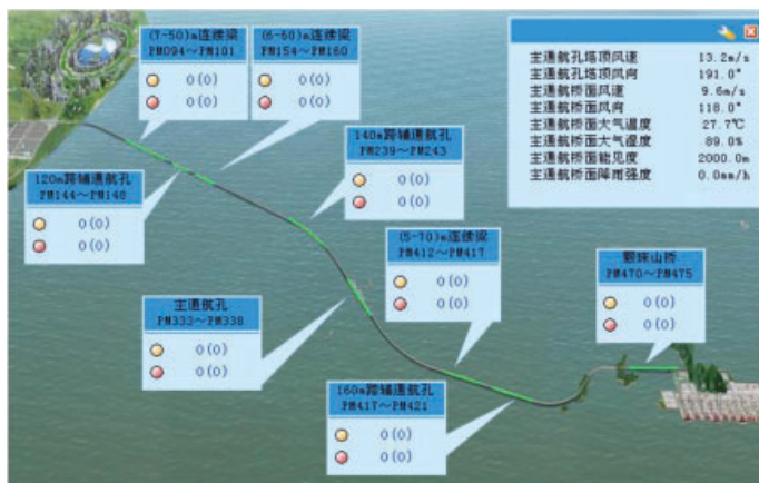
图 1 桥梁健康监测系统的预警监测图
