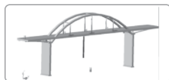
图 3 模型桥传感器布置位置示意图 图中:桥面上的长方片代表应变片,桥面及桥下的短圆柱体代表磁电式检波器,桥下的长条圆柱体代表涡流传感器(包括支架)
