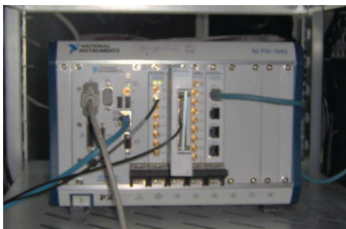
图4 PXI工控机箱硬件组成图
