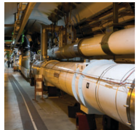
采用超导磁体控制粒子束轨迹, 蕴含的能量足以融化 500 kg 铜
