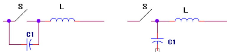
图11.17 零电压（ZVS）开关
