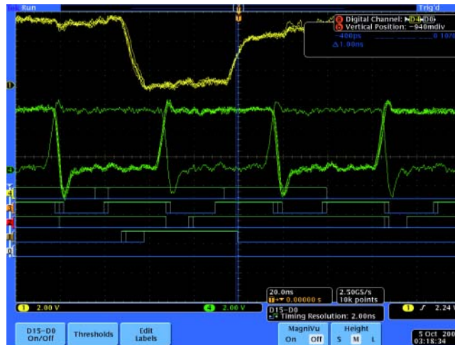
图4. 5秒的观察时间之后, Tek MSO4104 无法捕获偶发亚稳状态
