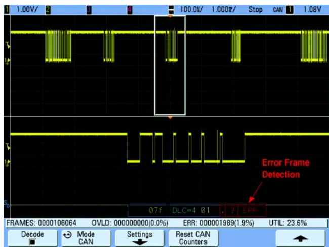
图7. Agilent MSO7104A 使用基于硬件的解码,能够可靠地捕获和解码CAN错误帧
