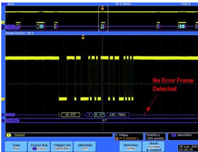
图 8. Tek MSO4104 未能捕获和解码 CAN 错误帧，基于软件的解码更新速率仅为每 5 秒 1 次解码
