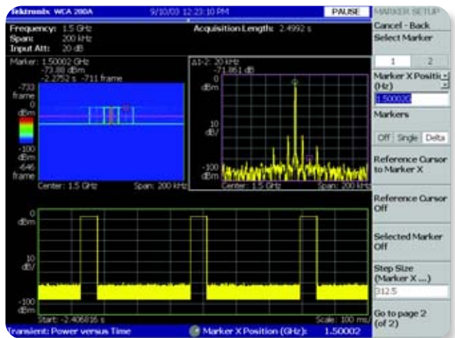
图 1-14: 显示频谱图、功率与频率关系及功率随时间变化的多域图。
