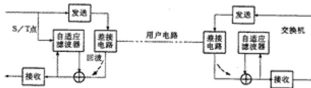
图9-5 回波抵消法原理图
