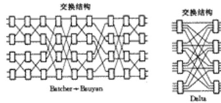
图 11-11 Batcher-Banyan 交换结构 图 11-12 Delta 交换阵列
