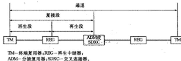
TM-终端复用器;REG-再生中继器;ADM-分插复用器;SDXC-交叉连接器。
