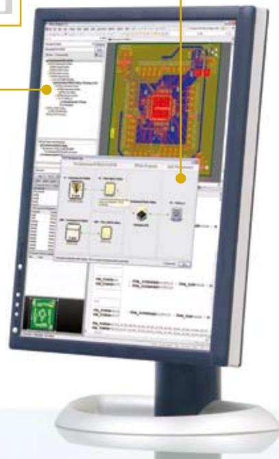
Altium Designer可结构化地把FPGA和PCB设计项目链接起来，用户可以并发地设计FPGA逻辑及其PCB板卡。Altium Designer会自动同步设计，确保项目进展。
