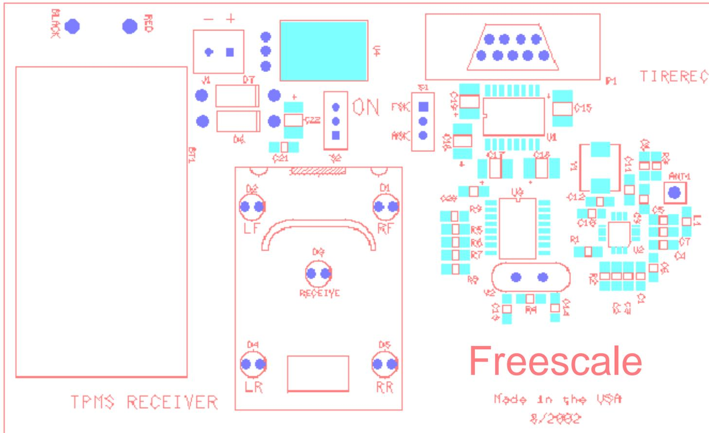
图6: TPMS接收器模块平面图
