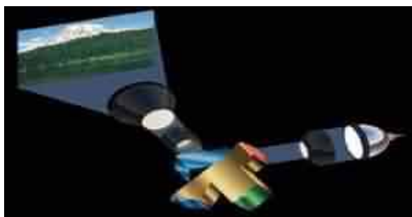
图 6 -2 : 三片 D L P 投影机系统。白光分解成原色，每一原色在整个帧时间内直接投射到它自己的 D M D 上，比颜色一顺序系统中产生更大的亮度。
