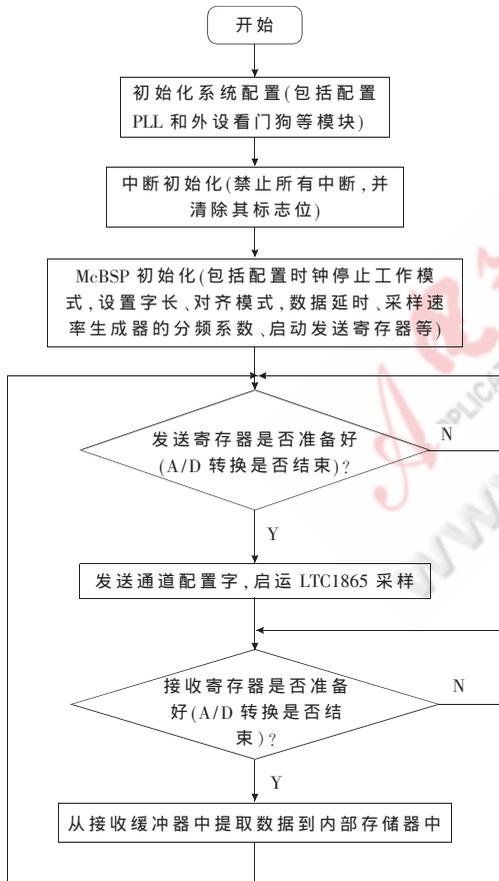
图4 McBSP与TLC1865串口通信的流程图
