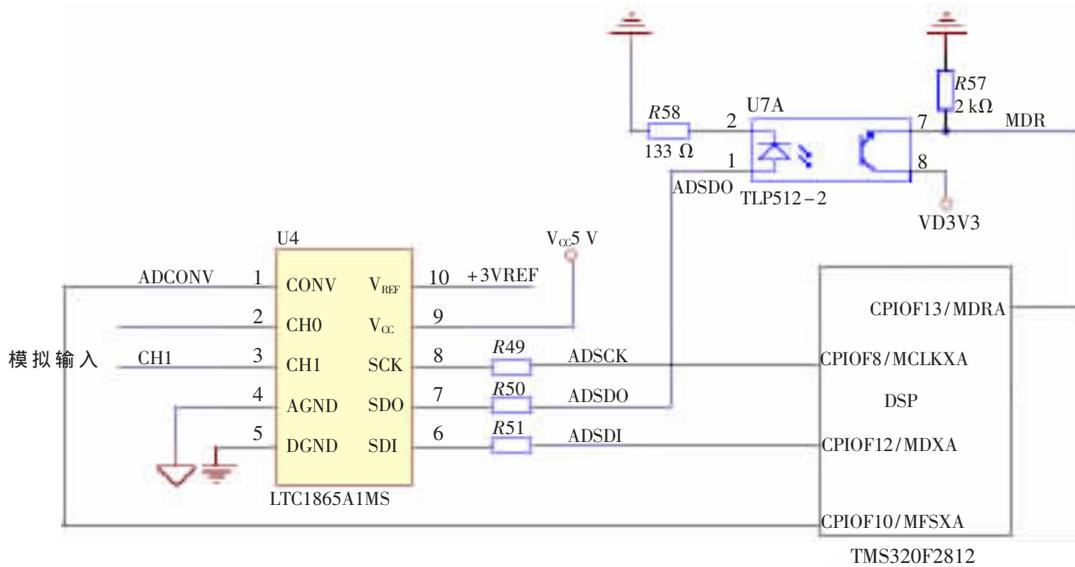
图3 McBSP与TLC1865的连接图
