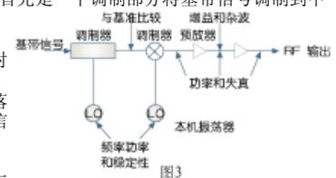
如何用频谱仪对这样一个发射机进行测量。首先对它的发射信号从测量端口进行测量（若是把发射信号直接送入频谱仪，必然会把仪器烧坏）。在这里我们要测其功效的失真，发射信号的频率、功率。对发射机内部预放失真、增益、噪声系数，混频器的输出功率，输入功率进行测量，得到混频器的差落损耗。对混频器的输出功率进行准确测量，了解其工作点。对混频器的本振信号进行测量，得出本振信号的输出频率，了解其频率精度。这个频率精度也就决定了发射机的精度。通过以上这些测量，可以得到对于发射机内部信号、器件和输出信号的多项参数，以描述这个发射机的性能。作为通讯的监测，一般不去检测其内部的器件，只检测其频率、功率。只要这两项指标正常，就可以判定这部发射机是正常工作。
