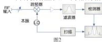
最基本的核心部分是它的混频器。基本功能是将被测信号下变至中频21.4MHz，然后在中频上进行处理，得到幅度。在下变频的过程中，是由本振来实现下变频的。本振信号是扫描的，本振扫描的范围覆盖了所要分析信号的频率范围。所以调谐是在本振中进行的。全部要分析的信号都下变频到中频进行分析并得到谱频。这与日常所用的电视机、收音机的原理是一样的。
