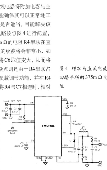
图 3 采用 375\text{m}\Omega ESR 设计, 请注意添加了 C7
