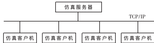
图 4 仿真实验平台结构框图
