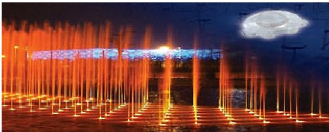
长约 600 多米的“祥龙”喷泉由数以千计的细小喷水口构建而成，形成一条全长两公里的水道，蜿蜒贯穿了奥林匹克公园。这些喷水口喷射出动态水柱，高度不一，最高可超过 6 米，远远望去波澜起伏，宛如一条腾云驾雾的祥龙。在每个水柱下方 10 厘米处都安装着一具灯座，每盏灯内都装有 24 个欧司朗的 Golden DRAGON LED，向上投射出高达 15 米的金黄色光柱。整个龙形水系喷泉共安装有 1920 套灯具，共采用了 46,080 个 Golden DRAGON LED。
