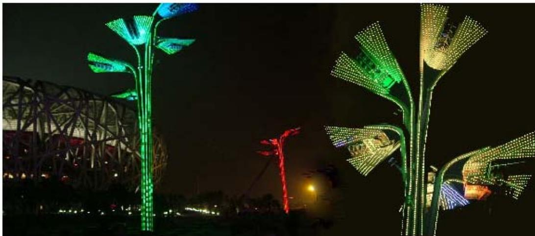
该项目位于鸟巢与水立方之间的奥运会场，共有29棵信息树，寓意传递第29届奥运会信息，每棵树高20米，直径3米，29颗树分布在三公里范围内，该项目要求实现每棵树能单独变化和集中控制，或所有树之间联动变化以及远程联动控制等，对控制技术是个极大的挑战，磊明根据项目特点，结合自身专利技术为该项目定制的Glamour Spot 全彩点光源及LMS灯光控制系统，结合电信级光纤网络，成功的解决了上述问题。
