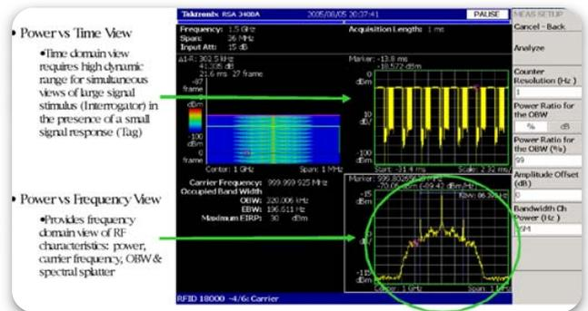
▶ 图 4-16. 通过通过显示频谱，进行 OBW/EBW 和 EIRP 测量
