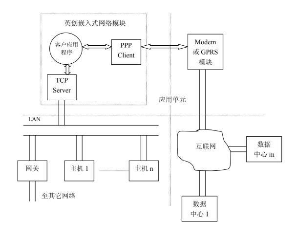
图 1 基于英创嵌入式网络模块的无线通讯应用方案框图
