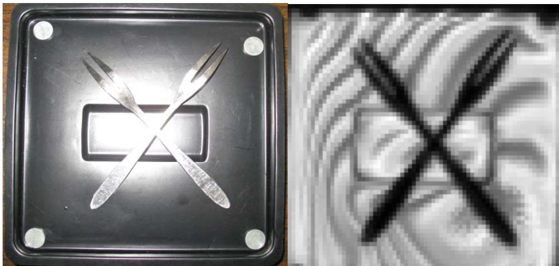
图4. 投射聚氯乙烯对金属成像 (a. 饭盒内的双叉实物 b. THz 投射系统成像)
