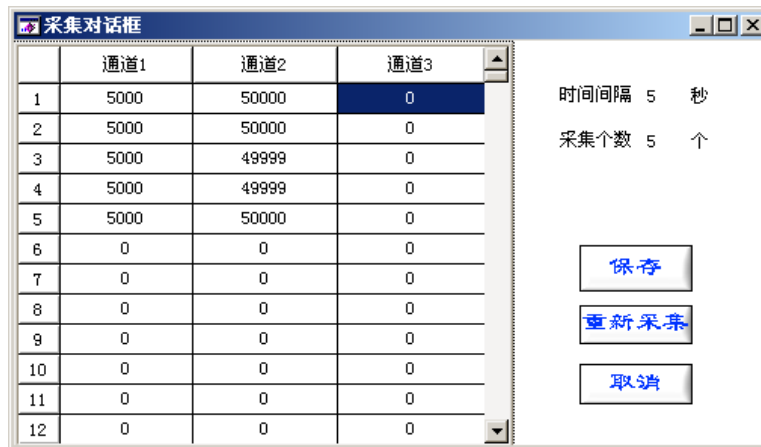
图4 连续时间间隔内计数监测画面（通道1：1k，通道2：10k）
