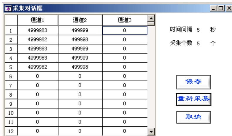
图4 连续时间间隔内计数监测画面（通道1：1M，通道2：100k）
