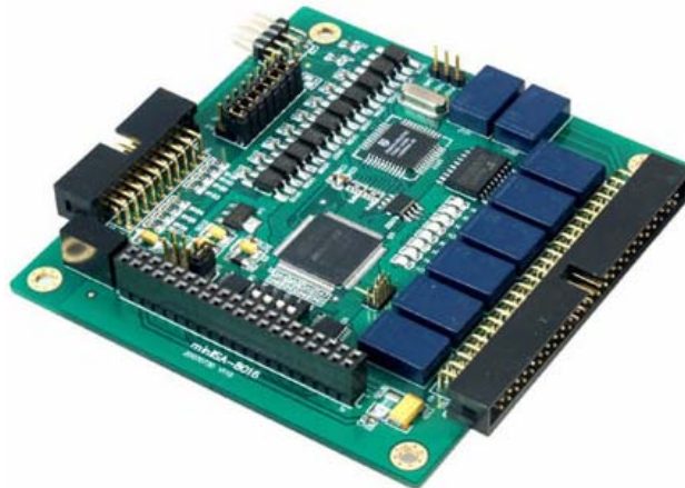
图 7 MiniISA-8016A 数字量输入继电器输出板卡
