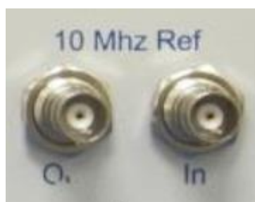
图 8 GX7200 后面板 10MHz 系统参考时钟输入输出
