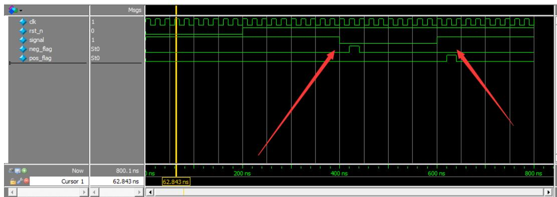
当输入信号有下降沿时， neg\_flag输出了高脉冲， 输入信号有上升沿时， pos\_flag输出了高脉冲。
