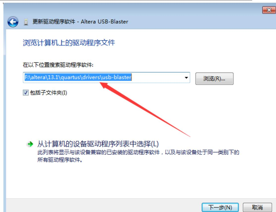
7. 按照笔者给大家提供的路径，大家可以去自己安装的盘符中寻找这个路径（在 usb-blaster 文件夹下，有 x64 和 x32，不要去选，直接选择 usb-blaster 就好了）。
