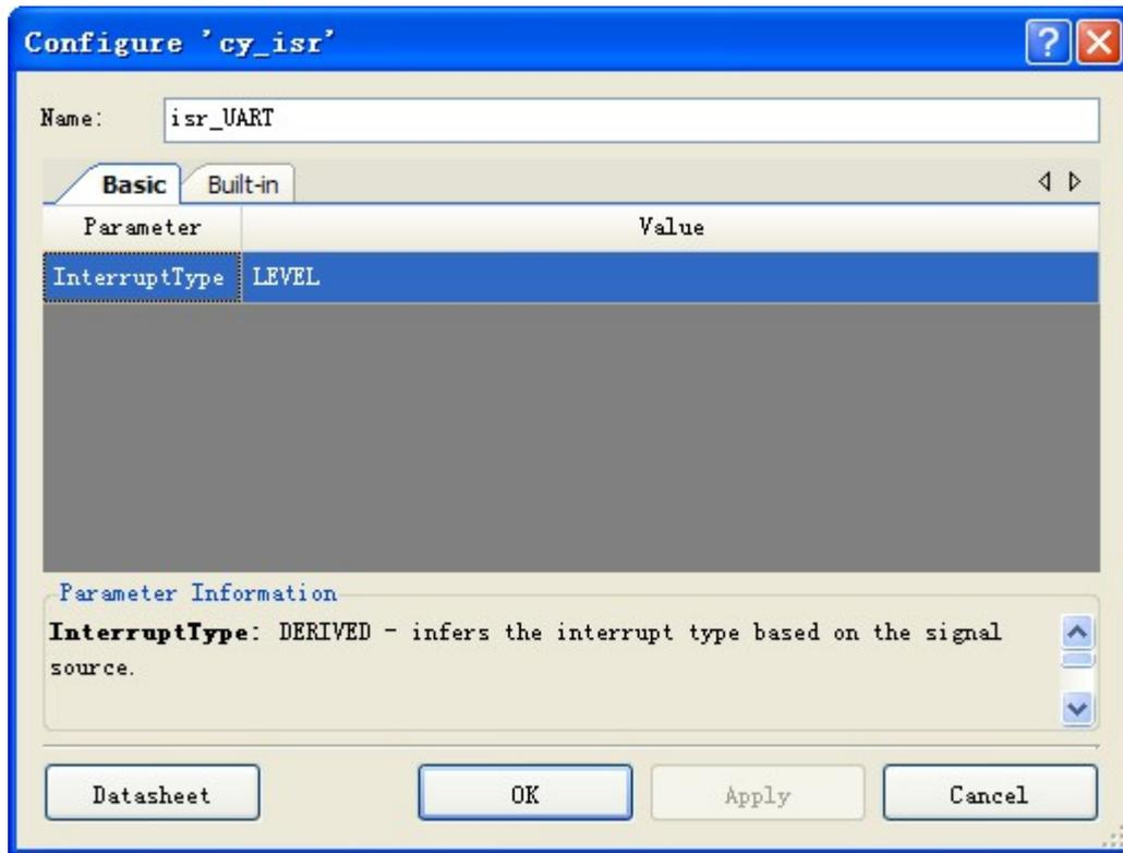
仅为基于UDB 的模块（如UART 和SPI）生成的中断选择LEVEL选项。其原因是这些模块通过生成一个电平中断来表示UD B FIFO 缓冲区的状态信号。深度为4 个字节的FIFO 缓冲区用于暂时存储传输（Tx FIFO）或接收的数据（Rx FIFO）。
