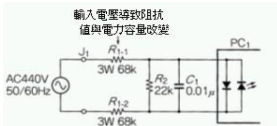
图 19 加大图 17 的 R1-1 R1-2 容许电力可支持大电压范围
