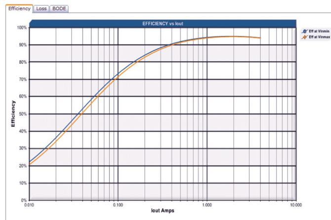
材料清单之后是“**图形**”部分，可能包括效率图、损耗图和闭环传递函数（波特图），所有图形都会显示最低输入电压和最高输入电压两种情况。效率和损耗曲线对应于许多高损耗参数取最差情况值时的损耗。这种最差情况分析一般贯穿于整个 ADIsimPower 设计流程。其目的是让用户确信：该工具所提供的设计稳定可靠，能适应所有元件误差、环境温度范围和其它电路变化。这款工具所提供的设计远远超出了基本解决方案的范畴。
