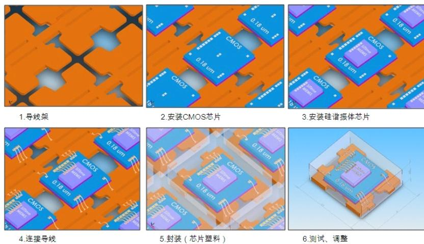
上面六幅图揭示了整个 SITIME [MEMS 硅晶振](#)的工艺流程，SITIME [MEMS 硅晶振](#)采用上下两个晶圆叠加的方式，外部用 IC 通用的塑料做为封装。不仅大大减少的石英晶振的
