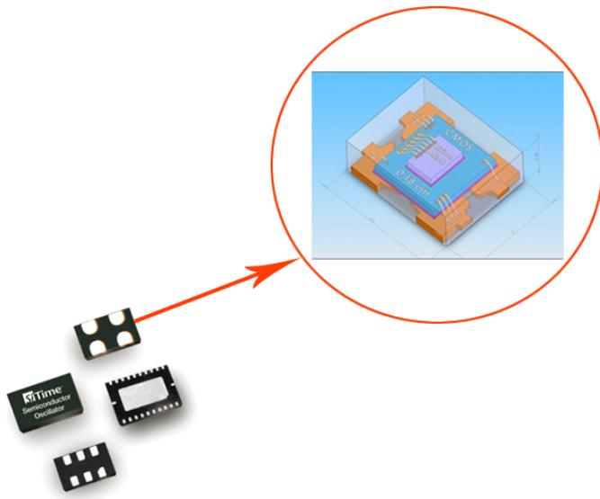
其实，就是相当于 SITIME 公司将石英晶振全面硅化，将其变成一颗芯片了。SITIME 公司的 [MEMS 硅晶振](#)采用全自动化的半导体生产工艺流程。以自然界中储量仅次于氧元素，位居第二的硅元素为生产材料。让高性能与低成本变成了，“鱼与熊掌，可兼得！”
