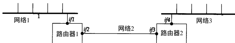
图8-3 traceroute 程序打印出的接口标识
