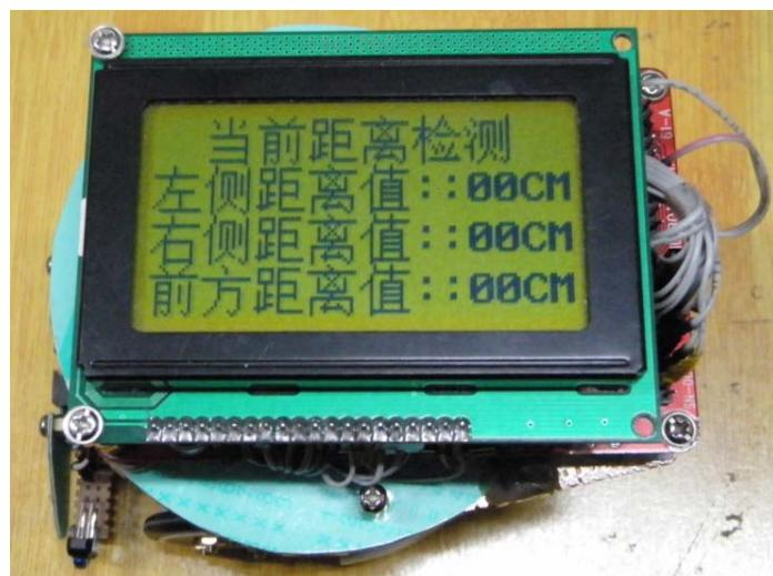
小车最后是要完成多个功能的，具体是怎样进行功能切换的呢？当然了，在这里我们还是通过液晶屏和键盘来进行切换的（如下图构建的几个画面）。在液晶屏处理程序中通过返回一个值，然后把一个对应的子程序代号通过串口发送到 51 机，让其 PC 指针转向对应的子程序段，从而实现功能的切换。
