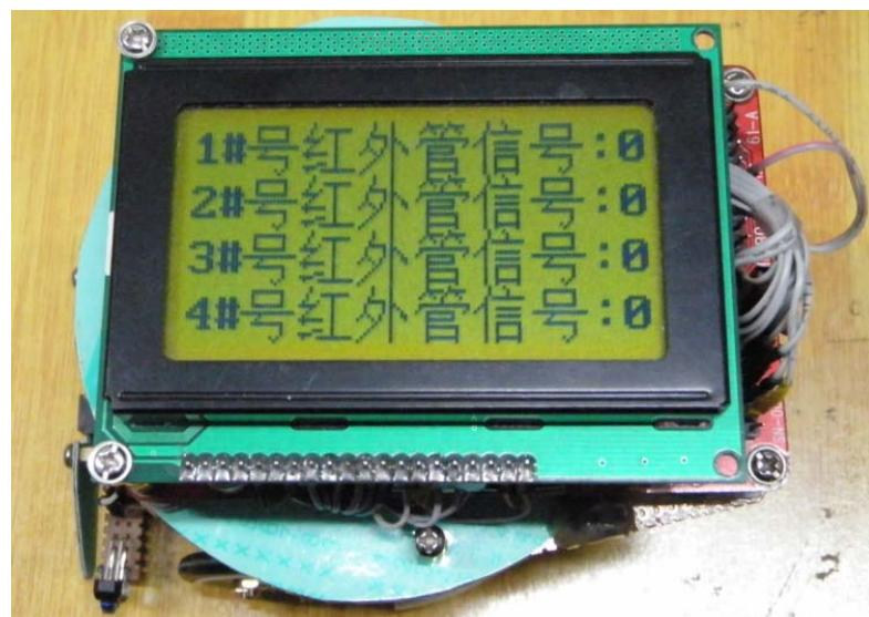
传感器需求：在完成此功能时只启用了四个红外对管，两个用于纠偏，两个用于对十字路口的判断及计数等，还有就是对小车车轮脉冲计数控制回车库了。分布位置如下图所示：
