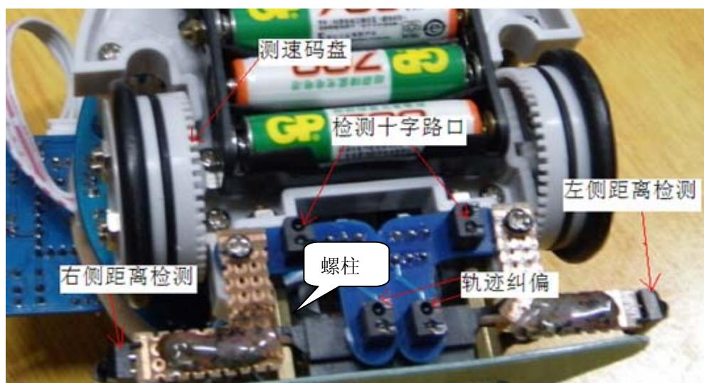
第七只红外对管安装位置如下图所示，其中需要留意的就是上图中安装的螺柱。由于用来安装红外管的直角板的引出线妨碍了 SHARP 测距传感器的安装，在此我们用螺柱把测距传感器顶到前面进行安装。如果觉得有点不美观，可以剪一个小挡板安装在前面，这样还有利于避免下面四只红外管受环境光的影响。如下图所示：
