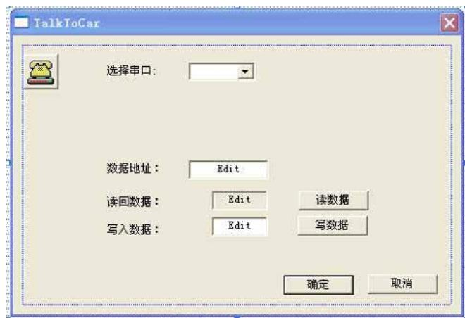
使用了如下四个素材：Static Text 、 Combo Box、 Edit Box、 Button：
