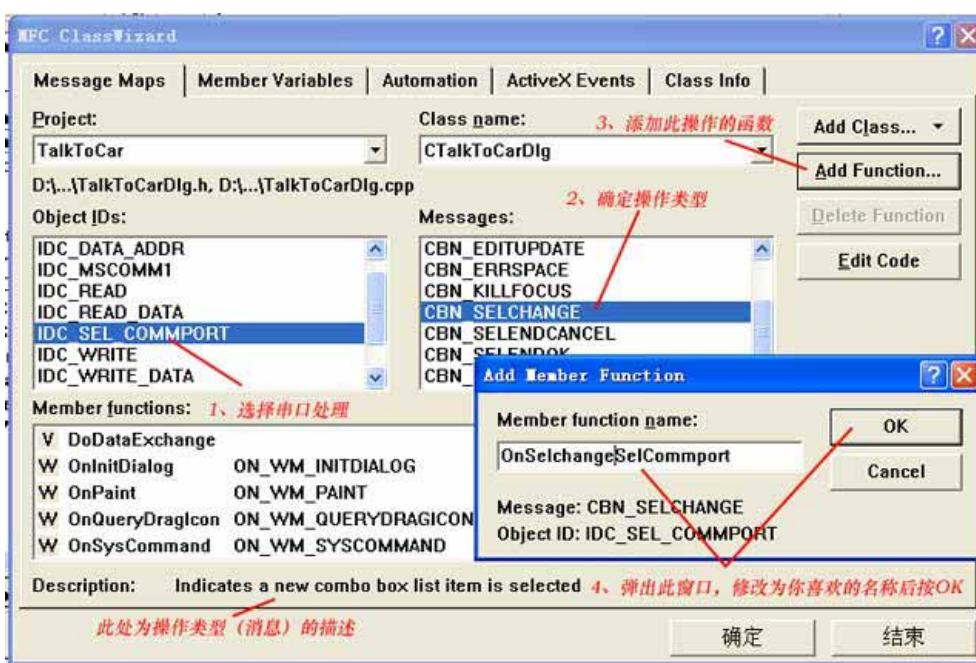
上图中的操作完成了“选择串口”功能的函数框架建立。Windows程序是消息驱动的，
