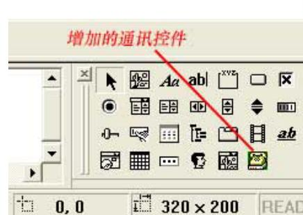
VC 编程与以前的概念有所不同，是先根据需要构建程序的显示界面，然后再将界面中的各个元素定义好，如按钮、显示内容栏等，在这个过程中 VC 帮你自动生成了对应的程序框架，并在框架中提示出添加处理功能的位置。
