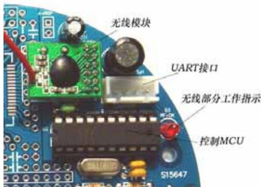
如需使用所提供的套件实现 PC 机与小车的无线通讯，建议按如下配置：
