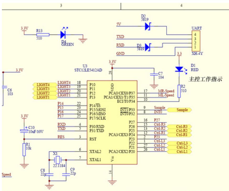
从图中可以看出，主控工作指示由 MCU 的 P3.4 控制，低电平亮、高电平灭。根据这个首先编一个简单的程序以实现对它的控制。
