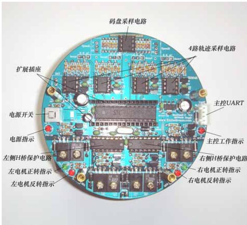
**电源开关** —— 只控制控制部分的电源，不控制 H 桥的电源；
