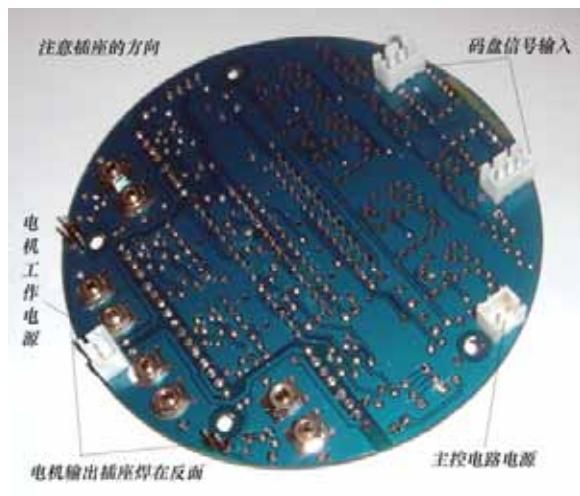
**主控电源插座** —— 提供控制部分的工作电源；
