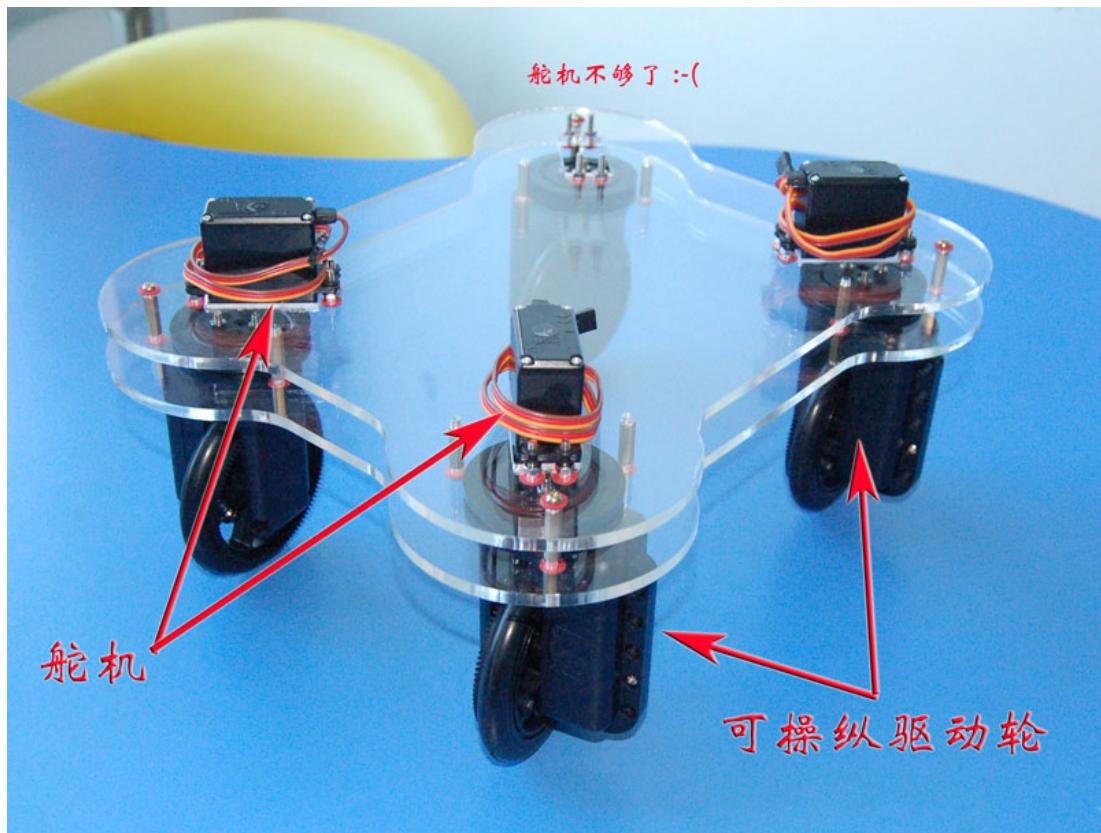
这是典型的用四个“可操纵驱动轮”构建的全向运动小车平台，可以实现平面上任意方向的平移和灵活转向，包括准确的原地旋转，平滑的弧线运动。
