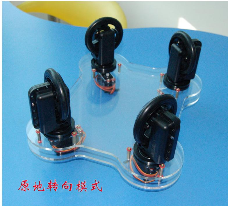
如果平台不是正方形，那舵机角度的控制将是挑战，必须让所有车轮方向是同一个圆的切线！
