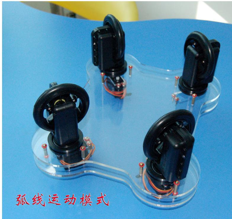
利用前后轮舵机的配合，可以实现比舵机转向方式小得多的转弯半径。
