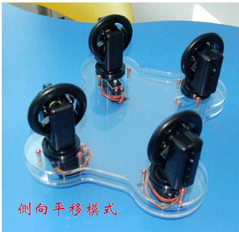
只要能让舵机同步转向，小车即可向任意方向平移，和直线行走一样流畅，此运动方式现实中似乎只有直升飞机可以实现。
