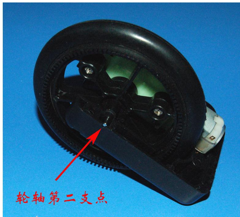
和圆梦小车一样，在车轮上设计了简易码盘，可以用遮断式光电采样器可靠地采集码盘信号：
