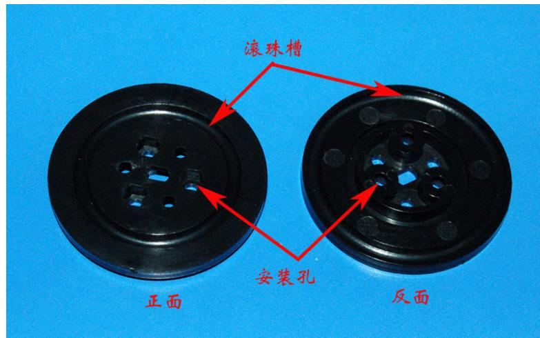
转盘上设计了方便的安装孔位，并设计了滚珠槽，可构成平面轴承，使得转向灵活，同时避免了晃动；加之模具保证了舵机轴和车轮着地点同心，大大减小了对舵机驱动力矩的要求。
