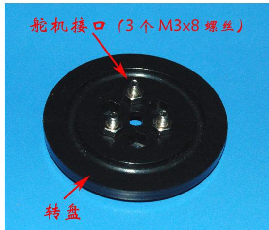
选择带有如下输出圆盘的舵机（如辉盛的 5010），按上图螺丝位置打三个直径 3mm 的孔：
