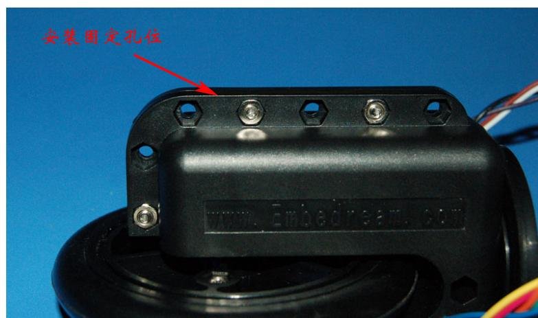
上有 7 个安装孔，既作为壳体装配孔，又可作为驱动单元固定在底盘上的安装孔。
