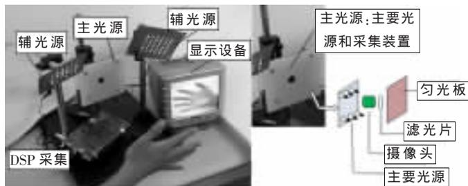
图1 装置实物图与采集装置分解图
