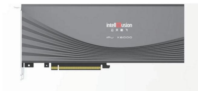
该产品具备 256T 算力、128GB 显存容量、486GB/S 显存带宽；采用 C2C Mesh 互联技术，可实现卡间高速互联，带宽达 64GB/s，最大可实现 64 张卡的互联；可应用于语言、
