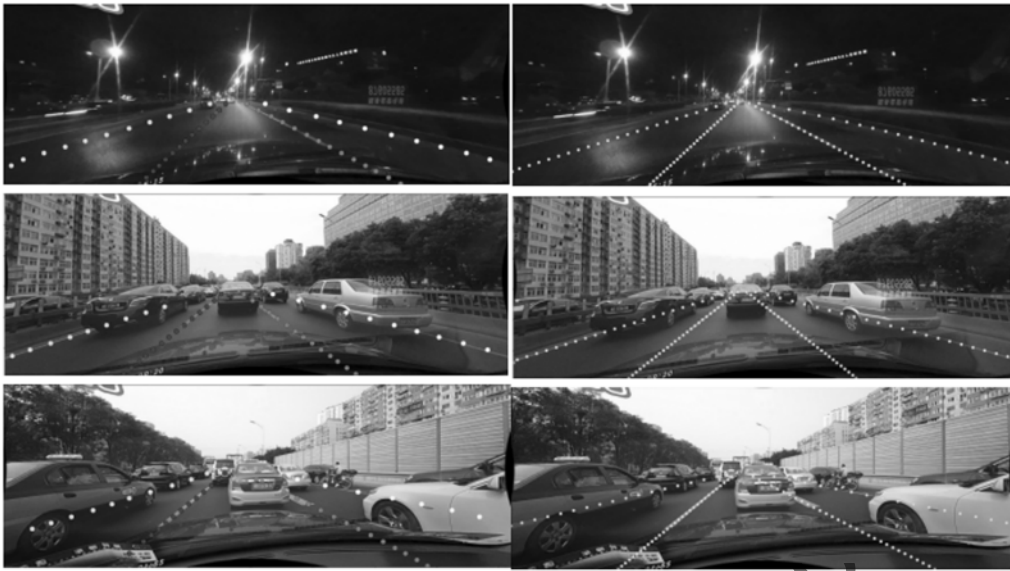
图6 CULane 数据集的标注与本文模型推断结果对比 (第一列为本文模型推断结果,第二列绿色点为 CULane 数据集的标注)
