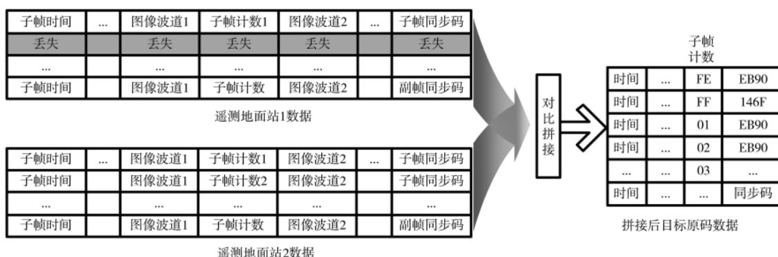
图 4 原始数据拼接示意图
