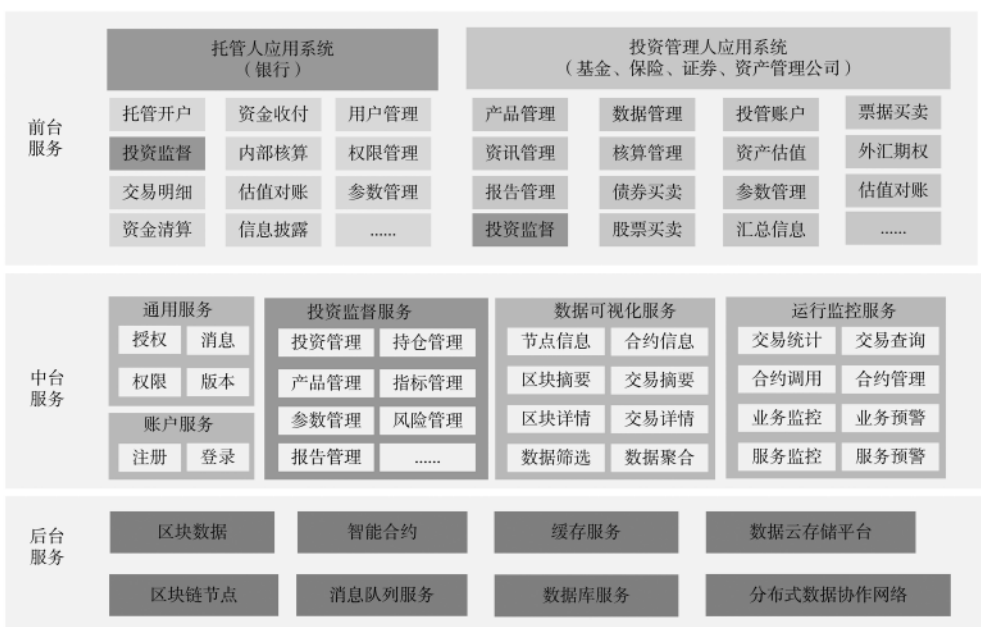
图 2 基于区块链平台的投资监督应用架构
