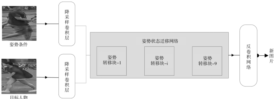
图 2 GAN 模型结构
