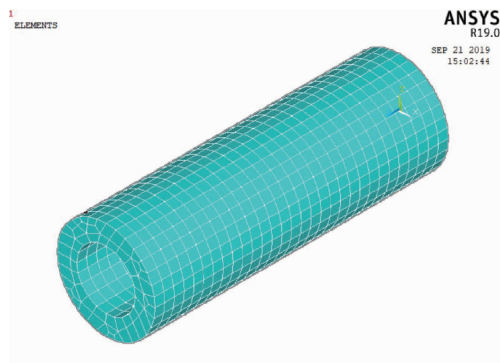
图 4 橡胶-金属缓冲弹簧有限元网格划分模型
