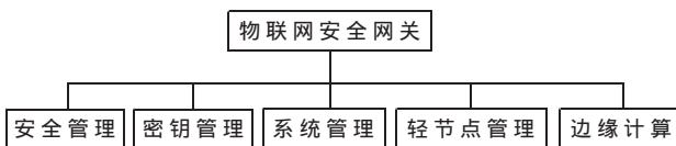
图 3 物联网安全网关功能子系统
