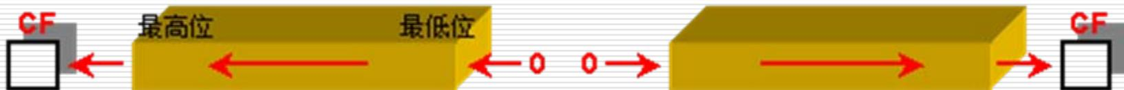
例5.11: 已知(AH) = 12H, (BL) = 0A9H, 试给出分别用逻辑左移和右移指令移动1位后, 寄存器AH和BL的内容。
