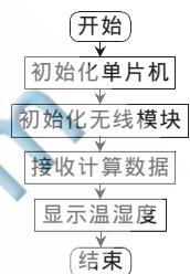
图 5 温湿度信息接收和显示流程图
