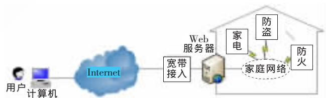
图 1 智能家居远程监控系统的总体结构
